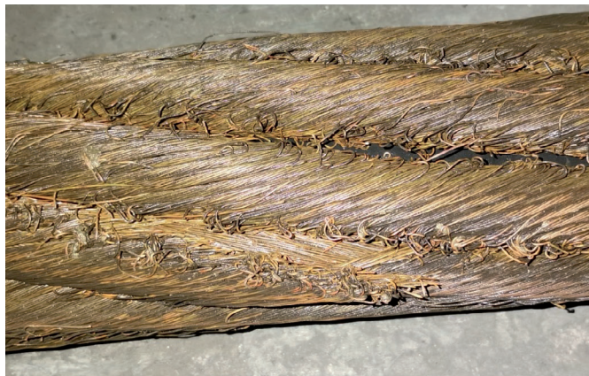
Рис. 11. Естественный износ кабеля при эксплуатации
