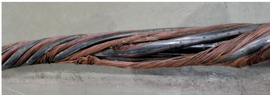
Рис. 13. Изменение шагов скрутки токопроводящих жил кабеля
