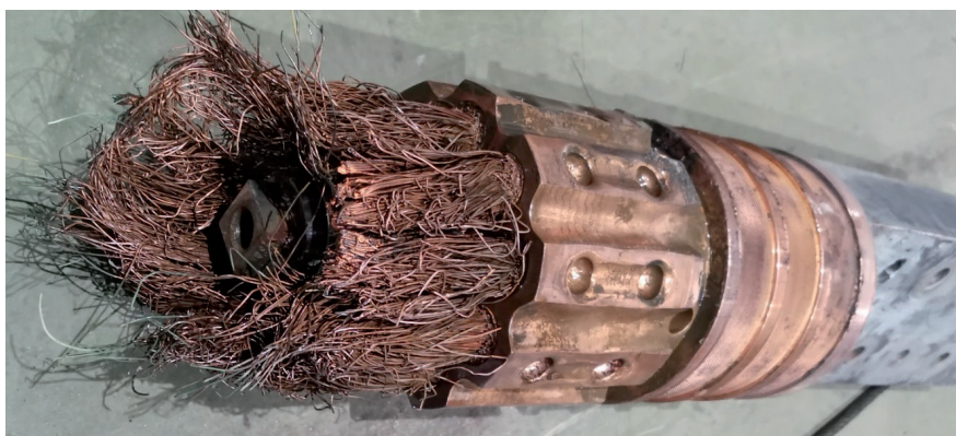
Рис. 14. Обрыв жил возле наконечника
