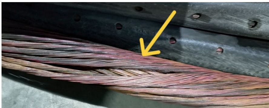
Рис. 5. Появление фиолетового цвета на меди
