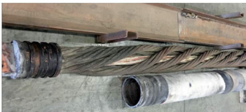
Рис. 9. Пример скрутки кабеля с опорным шлангом меньшего размера
