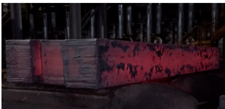
Рис. 1. Непрерывнолитые заготовки после нагревательной печи
