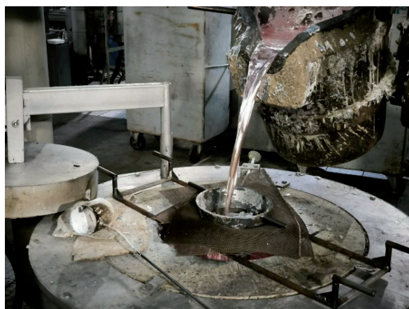
Рис.1. Процесс фильтрования сплава при разливке из плавильной печи в раздаточную через ФЭА
