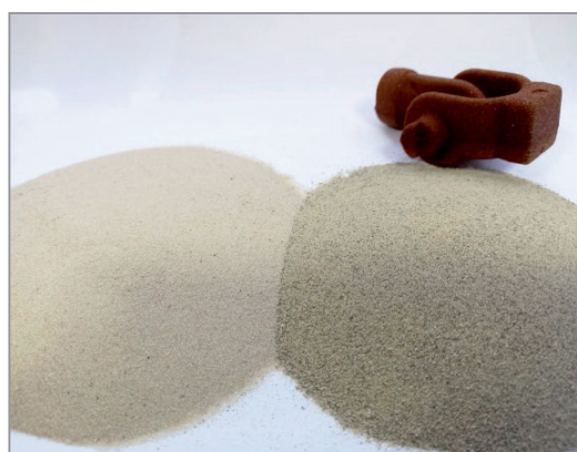
Рис. 3. Приготовленная смесь горячего и холодного плакирования на оборудовании ОАО «БЕЛНИИЛИТ», изготовленный стержень
