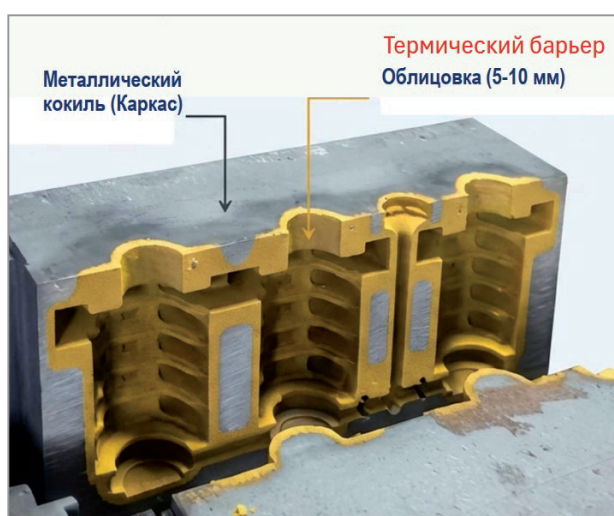
Рис. 5. Половинка облицованного кокиля, изготовленного на оборудовании ОАО «БЕЛНИИЛИТ»
