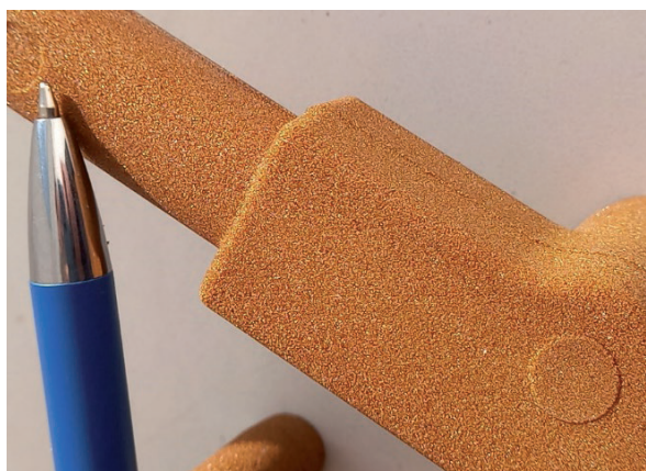
Рис. 10. Поверхность изготовленного песчаного стержня на стержневой машине ОАО «БЕЛНИИЛИТ» модели 4749
