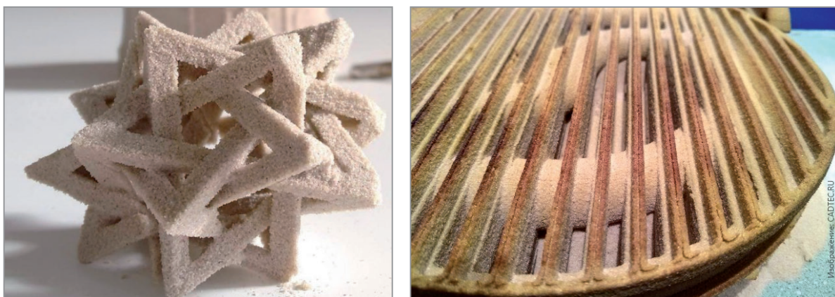
Рис.9. Поверхности полученных стержней методом послойной печати [23] и методом селективного плавления [24]
