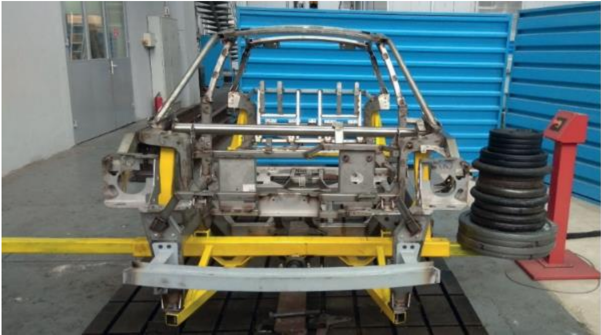
Рисунок 3.7. – Экспериментальная оценка напряженно-деформированного состояния кузова легкового автомобиля
