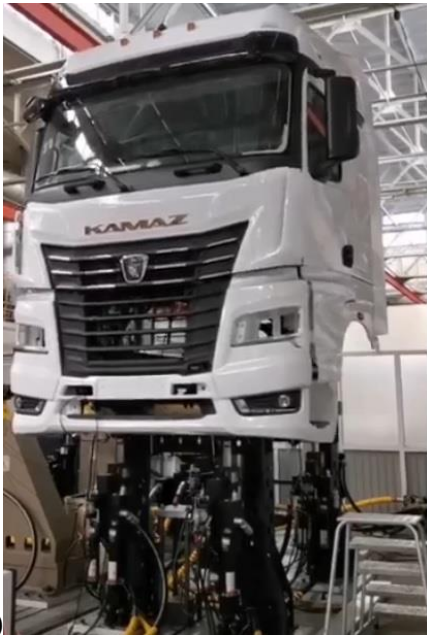
Рисунок 2.4. – Вибрационные испытания кабины (а), в качестве симулятора (б)
