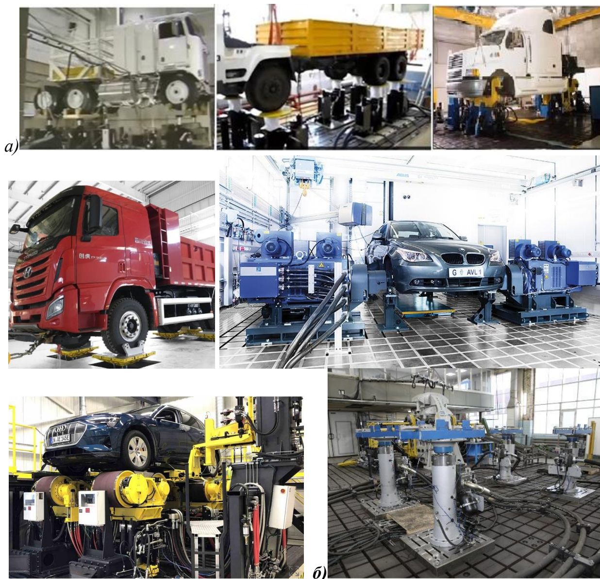
на вибростендах за рубежом (а), в НАМИ на 4-х пульсаторах (б) Рисунок 2.1. – Вибрационные испытания всей машины на стендах МТС
