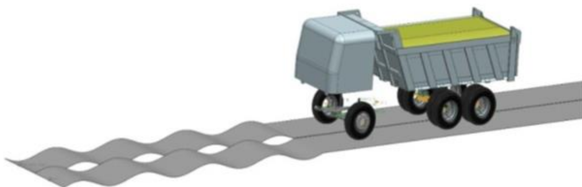
Рисунок 1.8. – Схема реализация в Simcenter моделирования автомобиля при переезде препятствий
