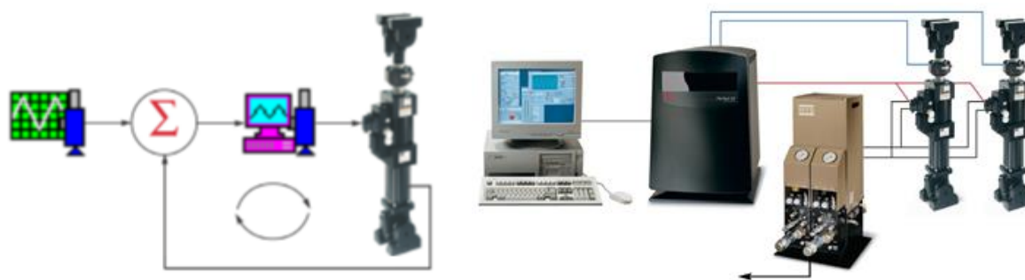
Рисунок 5.1 – Общая схема управления стендом MTS
