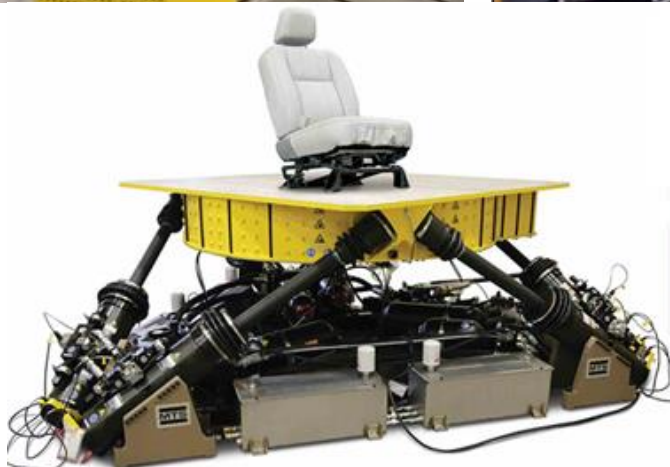
Рисунок 2.5. – 3-х осевая вибрационная площадка для испытания различных конструкций
