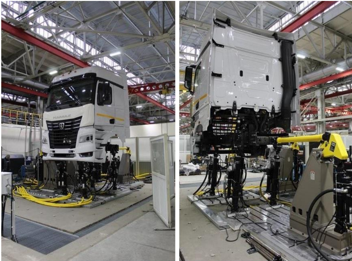
Рисунок 5.7 – Вибрационные испытания кабины на КАМАЗе
