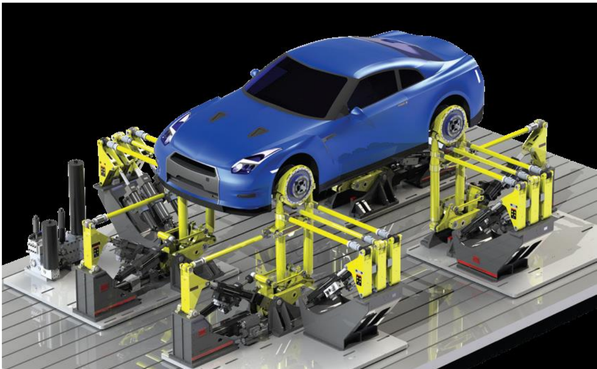
Рисунок 4.20. – Реализация многоосевого воздействия на ступицы на стенде через многорычажную систему с контролем нагрузок с помощью MTS SWIFT Evo
