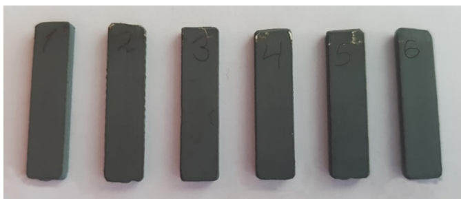
Рис. 1. Внешний вид обработанных образцов из титана ВТ1-0
