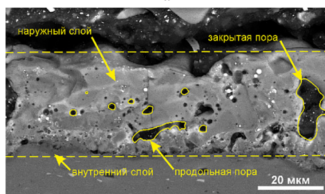
Рис. 6. Структуры покрытий, сформированных с применением электролитов SAT ( a ) и SPF ( б )
