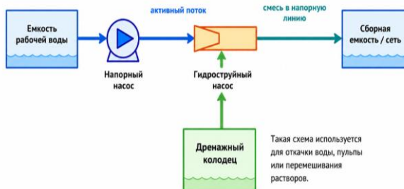
Рис. 2. Пример применения гидроструйного насоса в хозяйственной системе
