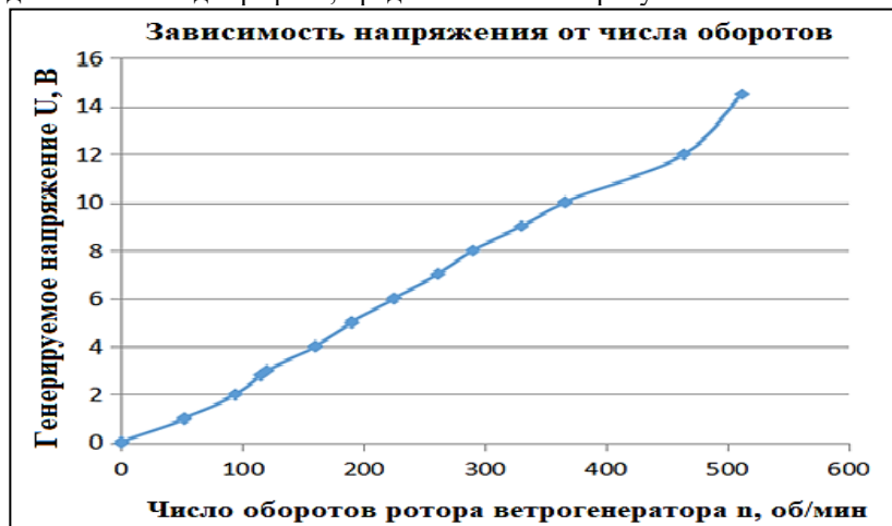
Рисунок 2. График изменения генерируемого напряжения (В) от числа оборотов ротора ветрогенератора (об/мин)
