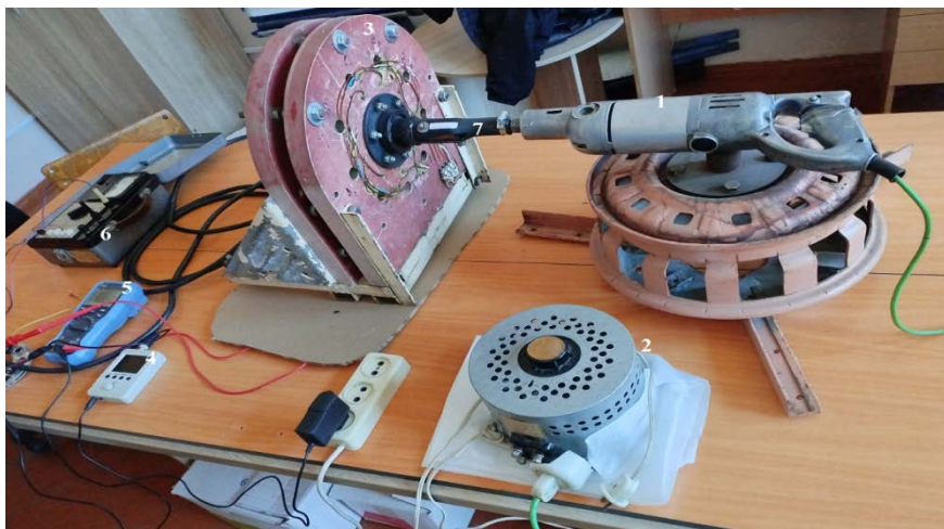
Рисунок 3 Установка для лабораторного исследования сконструированного ветрогенератора с улучшенными техническими характеристиками.
