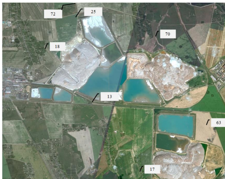
Рисунок 1 – Схема расположения наблюдательных скважин в зоне влияния солеотвала РУ №2 (космоснимок)
