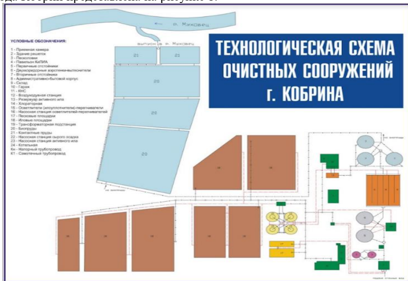
Рисунок 1 – технологическая схема очистных сооружений города Кобрин
