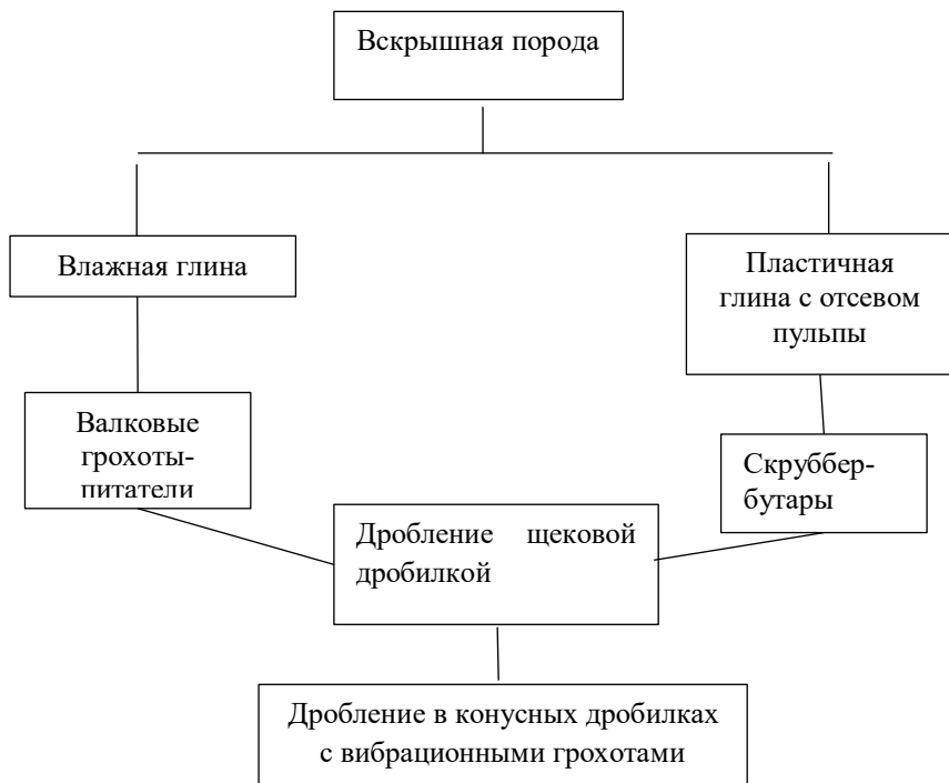
Рисунок 1 – Схема получения техногенного щебня из вскрышной породы
