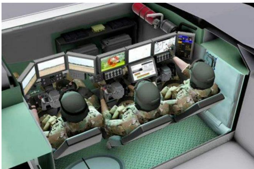
Рисунок 2 – Расположение экипажа в Abrams X. Слева – механик-водитель, по центру – командир и справа – наводчик
