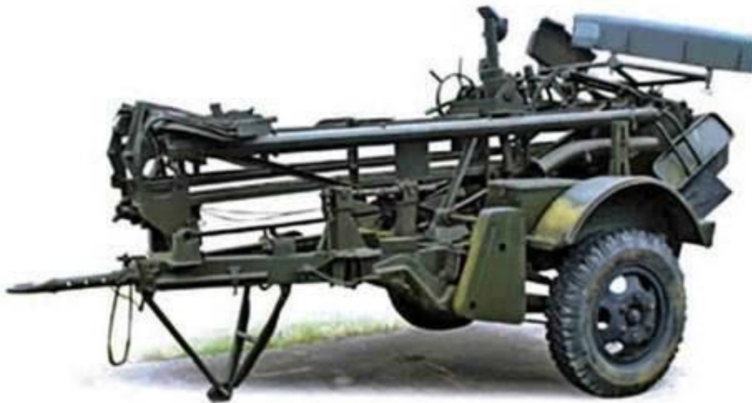
Рисунок 1 – Прицепной минный заградитель ПМЗ-4
