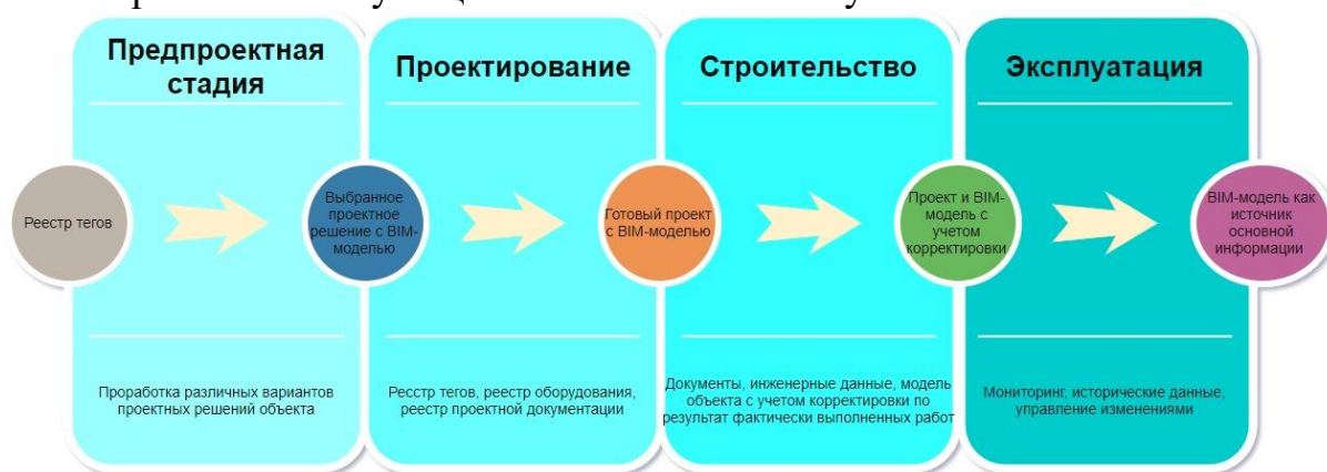
Рис.1. Трансформация BIM-модели на различных этапах жизненного цикла объекта недвижимости.
