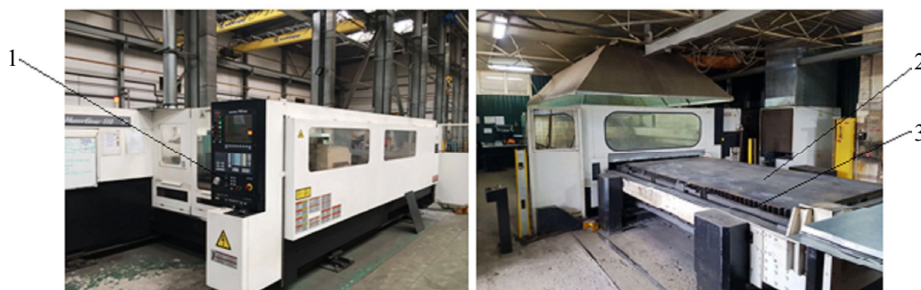
Рис. 1. Внешний вид комплекса лазерной резки Hyper Gear 510: 1 – модуль лазерного станка; 2 – лист для лазерной резки; 3 – паллета
