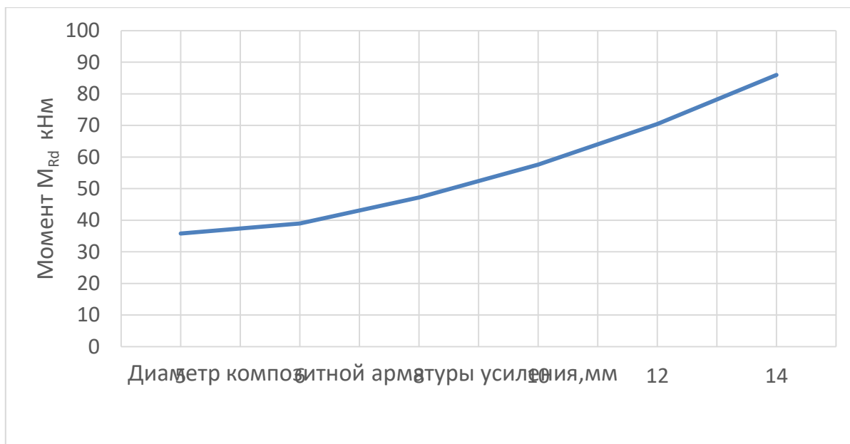
Рис. 10. График зависимости несущей способности плиты от диаметра композитной арматуры усиления
