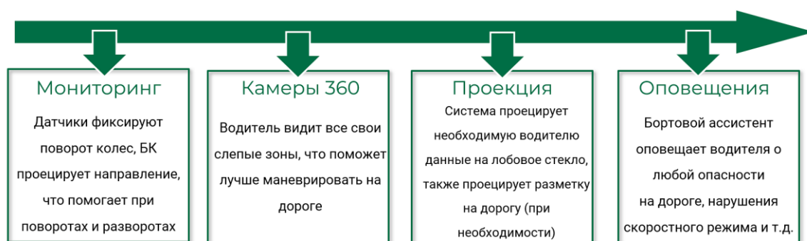
Рис. 1. Принципиальная схема работы системы кругового обзора
