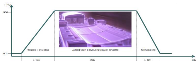
Рис. 1. Процесс ионно-плазменного азотирования крупногабаритных штампов
