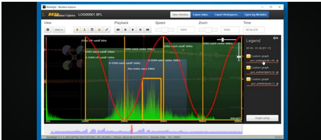
Рис.2 Режекция пиков вибраций на частотах 200 и 270 Гц
