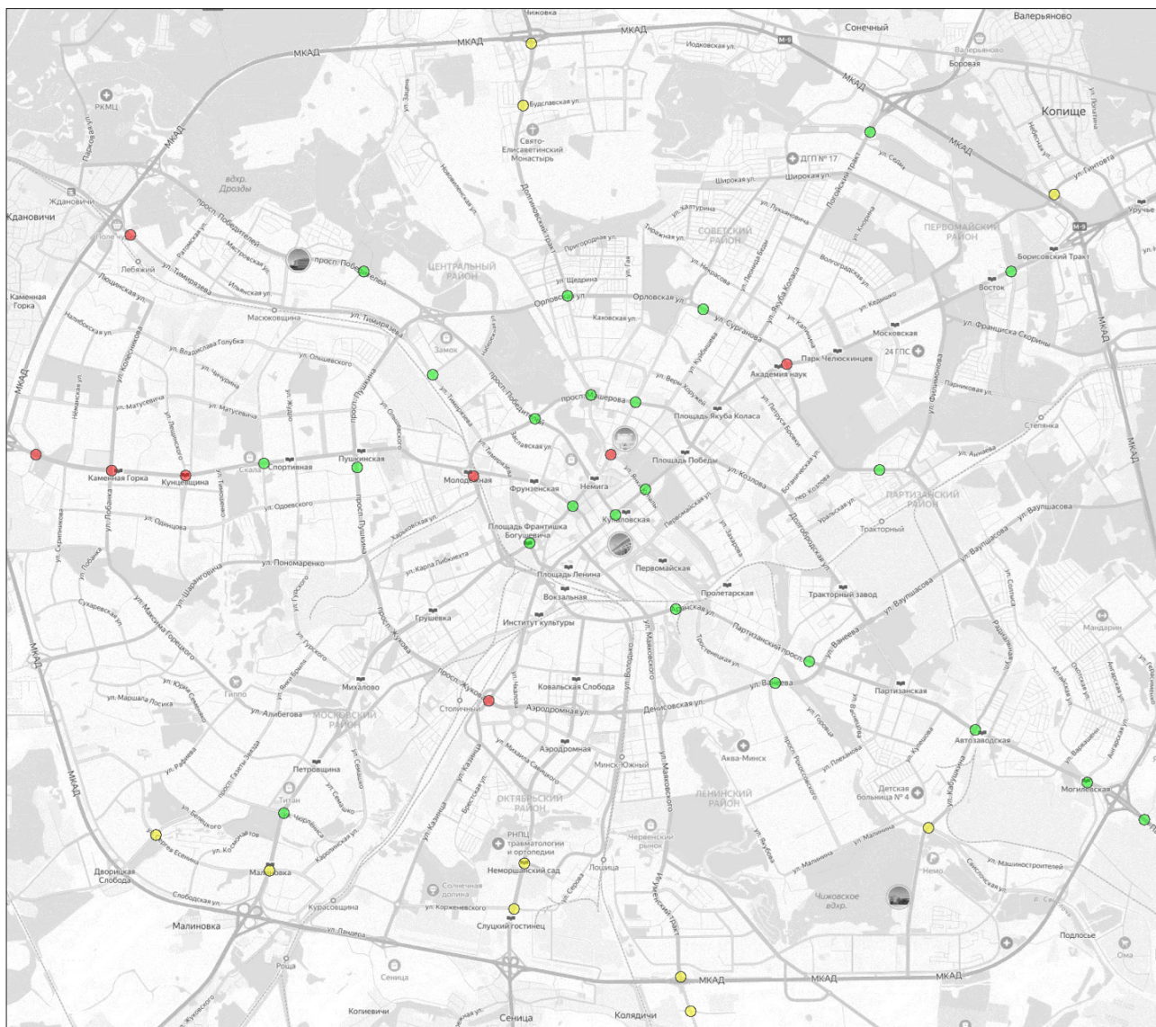
Рисунок 5. Расстановка Bluetooth-детекторов на улично-дорожной сети г. Минска
