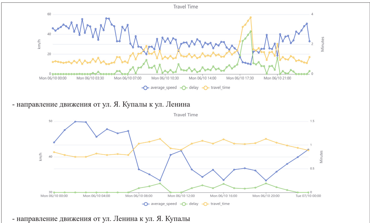
Рисунок 2. Распределение средней скорости движения транспортных средств по времени суток на перегоне ул. Я. Купалы – ул. Ленина в прямом и обратном направлении
