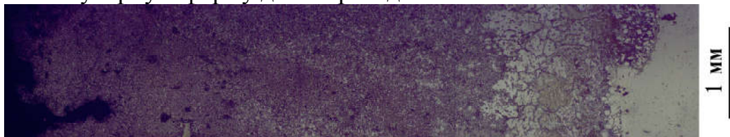
Рисунок 1 – Структура покрытия из сплава ЦАМ10-2 модифицированного нанонаполнителем TiC-Al 2 O 3
