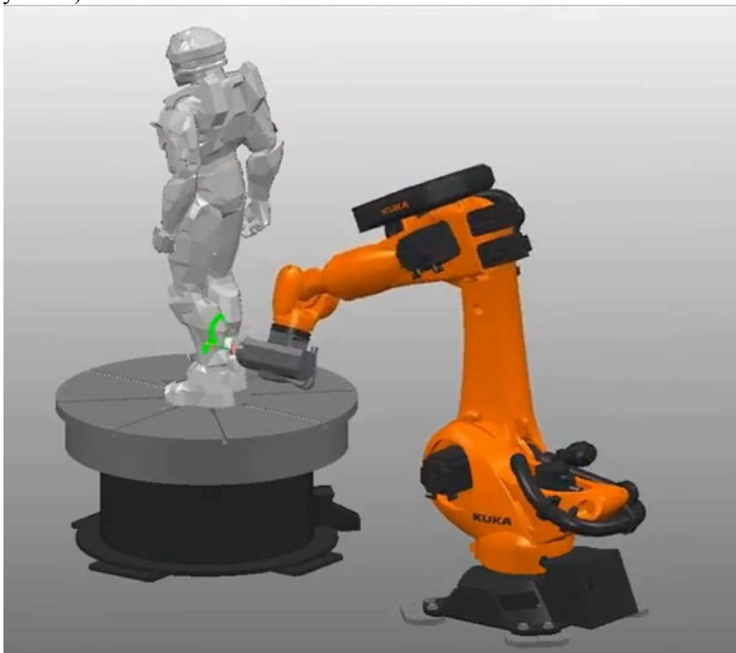
Рисунок 1 – Фрезерование сложной детали роботом КУКА
