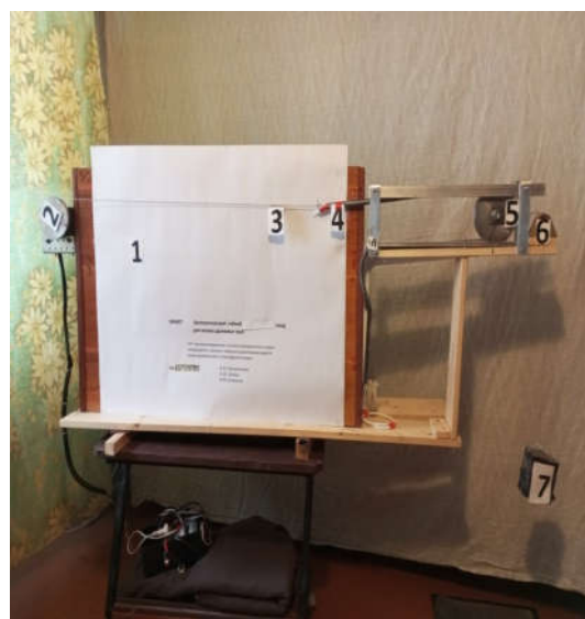
Рисунок 1 – Применение гибкого зонда с блок-роликом, а –пробоотборная система, б – лабораторный макет
