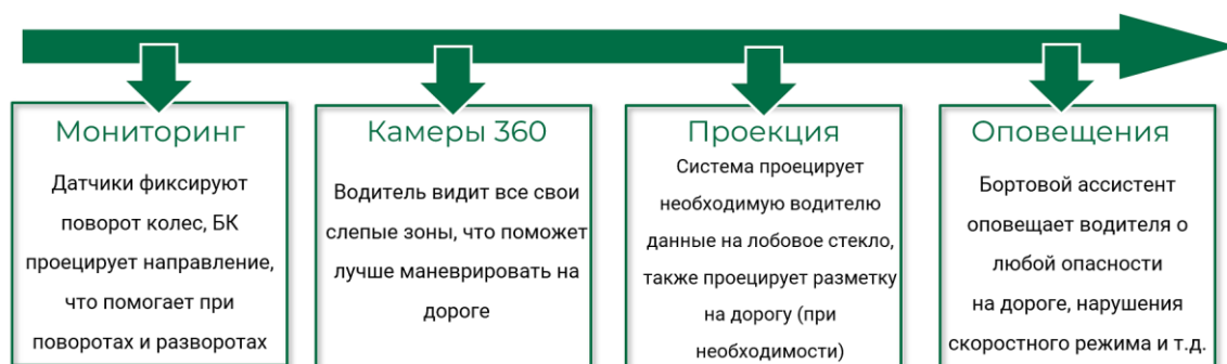
Рис. 1. Принципиальная схема работы системы кругового обзора
