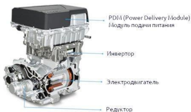
Рис. 1. Компоновка элементов электрической движущей части
