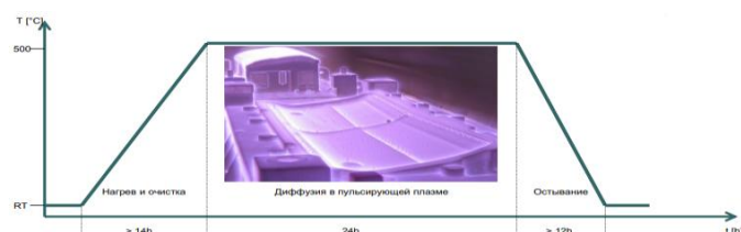
Рис. 1. Процесс ионно-плазменного азотирования крупногабаритных штампов
