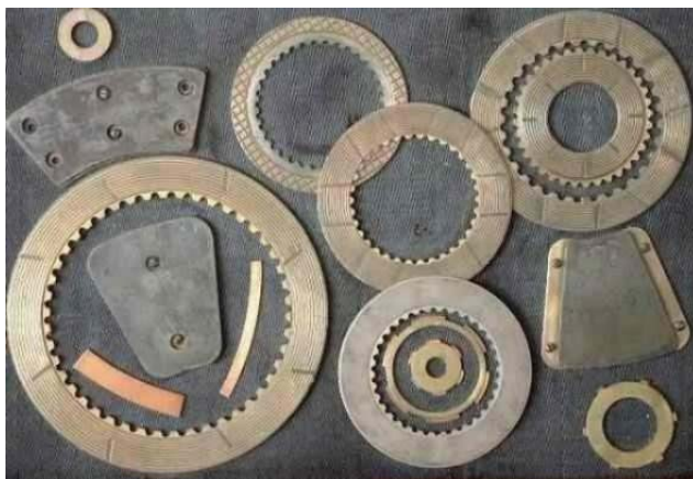
Рис. 32. Фрикционные материалы: а – изделия из спеченных фрикционных металлопорошков; б – припекаемые к основе под давлением керамические фрикционные накладки [13]
