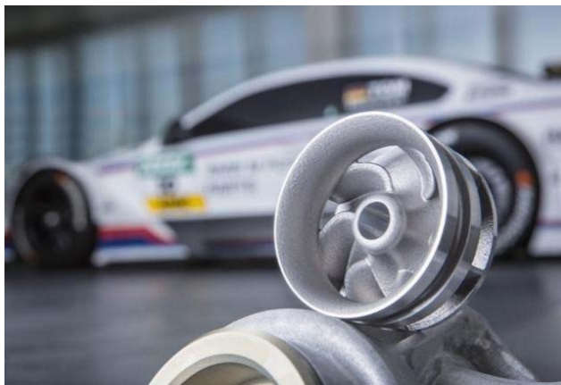
Рис. 6. Напечатанная на 3D-принтере крыльчатка помпы для автомобиля BMW гоночной серии
