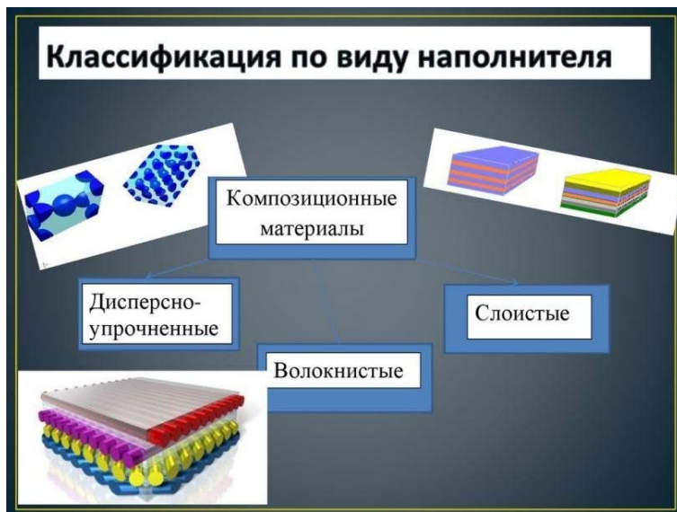
Рис. 14. Классификация КМ по виду наполнителя
