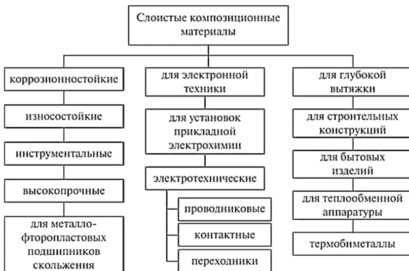
Рис. 20. Классификация слоистых КМ по способу применения
