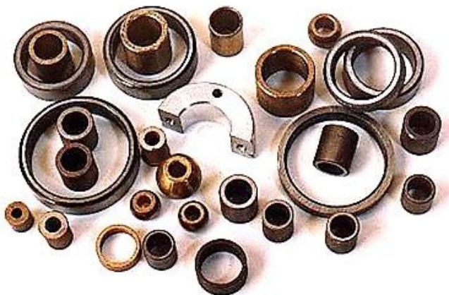
Рис. 31. Образцы изделий из антифрикционных материалов [19]
