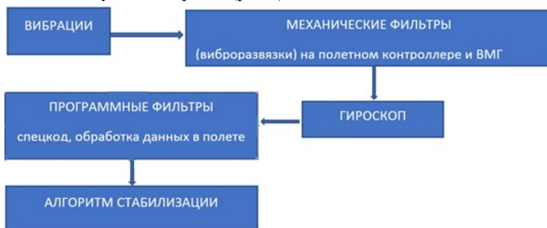
Рис.1 Структурная схема системы защиты агродрона от вибраций
