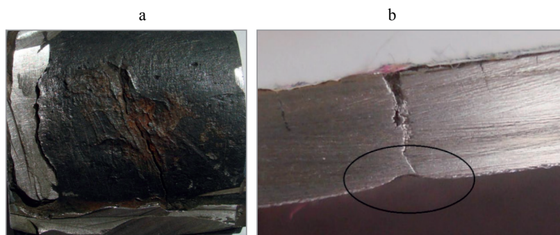
Рис. 5. Сквозное повреждение трубы: а – наружная поверхность стенки трубы;
