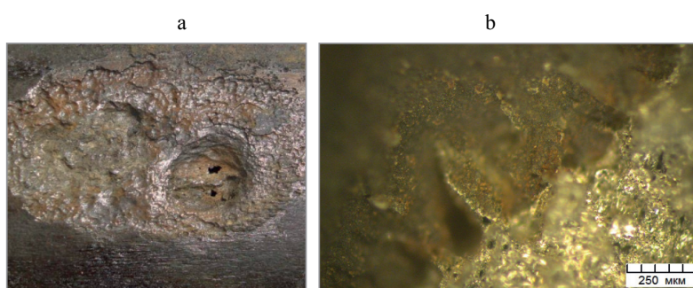
Рис. 6. Участок трубы со сквозным коррозионным повреждением после удаления неметаллических отложений: а – наружная сторона; б – поверхность излома в зоне окисления [12]
