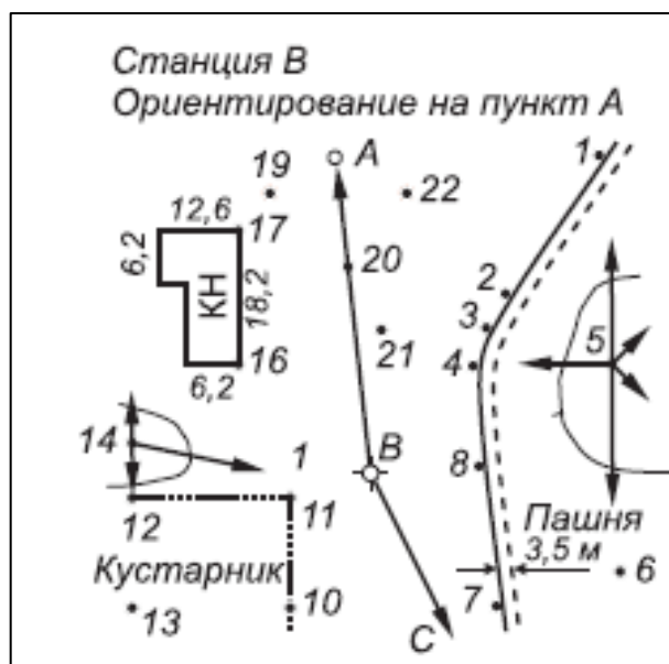
Рисунок 10.3 – Абрис тахеометрической съемки
