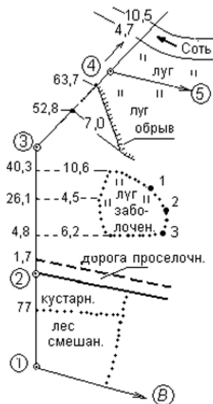
Станция (2). Съёмка части контура луга
