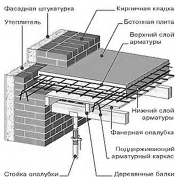
Рис. 3.2. Монолитное железобетонное перекрытие
