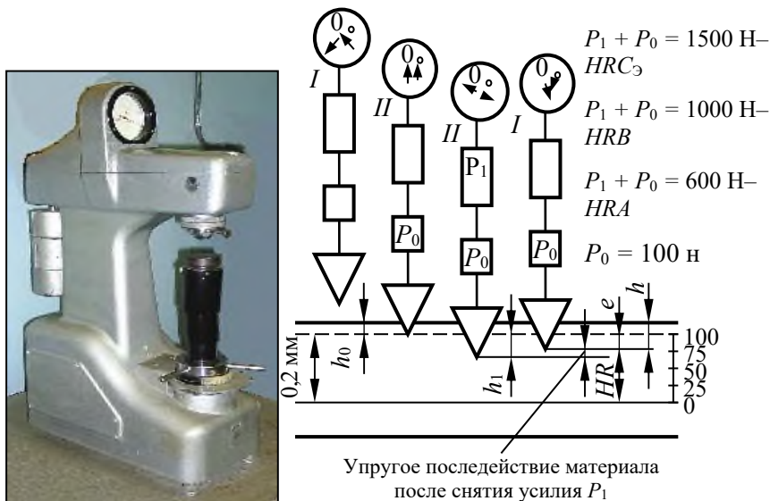
Рис. 1.3. Твердомер ТК2Б и схема измерения твердости по Роквеллу
