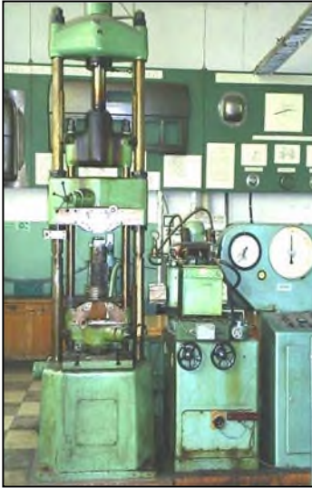
Рис. 2.1. Гидравлический пресс для испытаний на растяжение
