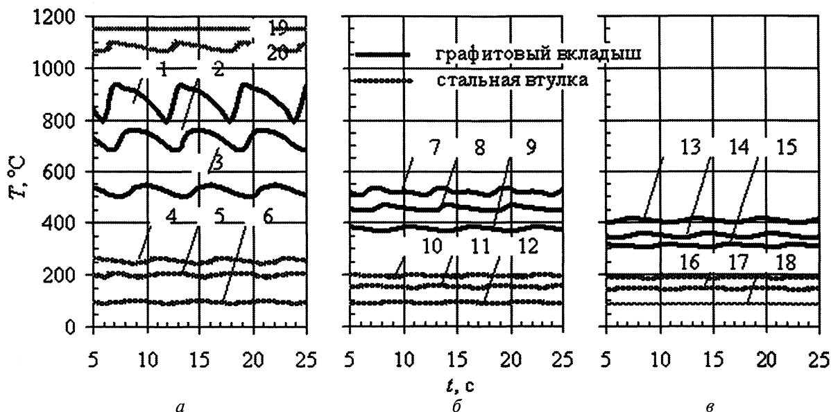
Рис. 2. Температурный режим комбинированного кристаллизатора: а – I пояс; б – II пояс; в – III пояс термопар; 1–20 – номер термопары
