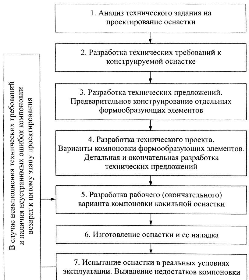
Общая алгоритмическая схема процесса проектирования кокильной оснастки
