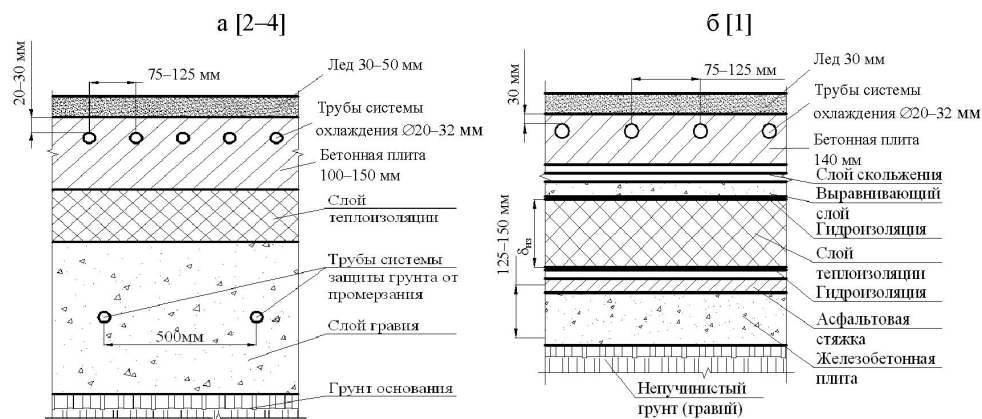
Рис. 1. Варианты конструкции оснований ледовых полей
