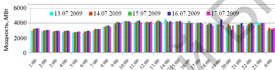
Рис. 5. Суточные графики нагрузки энергосистемы за рабочую неделю межотопительного периода
