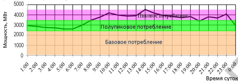
Рис. 4. Суточный график нагрузки энергосистемы за 13.07.2009
