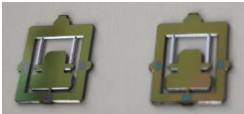
Рисунок 1 – Кремниевый чувствительный элемент датчика угла наклона
