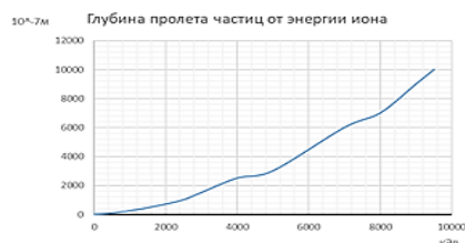
Рисунок 2 – Глубина пролета частицы водорода от энергии иона в композитном материале
