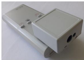
Рисунок 2 – Фото ФЭМ БСК для контроля линейных перемещений
