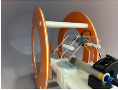
Рисунок 1 – Расположение антенны компаратора в полеобразующей системе эталона
