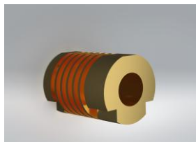
Рисунок 2 – Медное основание микрочип лазера
