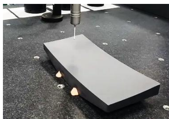
Рисунок 2 – Контактный способ измерения поверхности асферического зеркала
