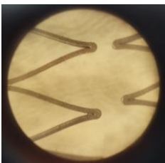
Рисунок 5 – Оптическое изображение после пескоструй в режиме Е. Умеренное удаление с повышенной шероховатостью
