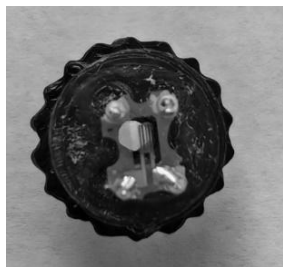
Рисунок 1 – Смонтированный пеллистор в корпусе из PETG
