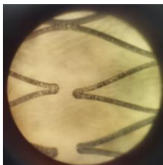
Рисунок 1 – Оптическое изображение после травления в режиме А. Оксидная пленка частично удалена, видны микропоры
