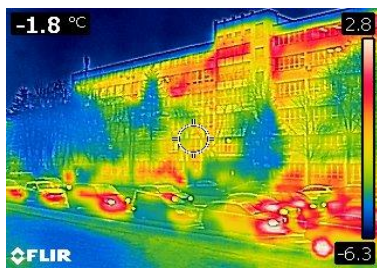
Рисунок 3 – Пример тепловых потерь в здании с системой терморегуляции помещений
