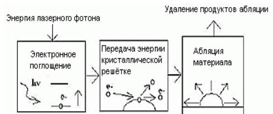
Рисунок 3 – Схематическое представление последовательности лазерной абляции
