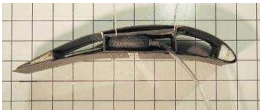
Рисунок 3 – Модель морфного крыла с приводом МакКибена под давлением
