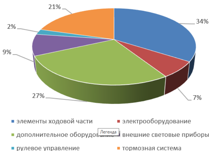
Рисунок 2 – Процентное соотношение неисправностей МАЗ-365022
