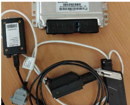
Рисунок 2 – ЭБУ Январь 7.2, K-Line адаптер ScanMaster CAN и скобы для подключения к Январю 5.1, 7.2
