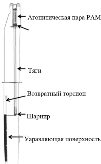
Рисунок 1 – Схематическое описание системы PAM TEF
