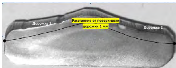
Рисунок 10 – Схема измерения твердости по контуру рабочей поверхности внутреннего кольца подшипника из стали У8А после объемно-поверхностной закалки
