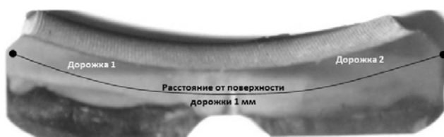
Рисунок 7 – Схема измерения твердости по контуру внутренней поверхности наружного кольца подшипника из стали У8А после объемно-поверхностной закалки
