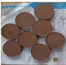
Рисунок 1 – Общий вид лигатуры для наномодифицирования на основе меди, содержащей оксид иттрия
