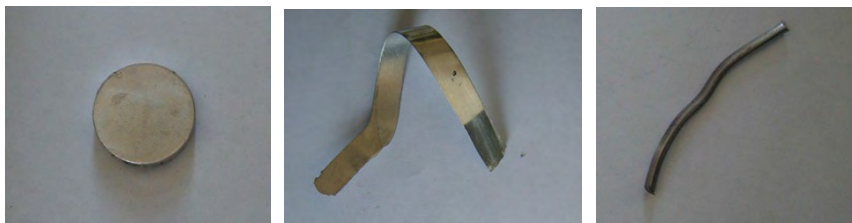
Рисунок 4 – Общий вид микролигатур на основе олова с добавками ультрадисперсного порошка оксида иттрия
