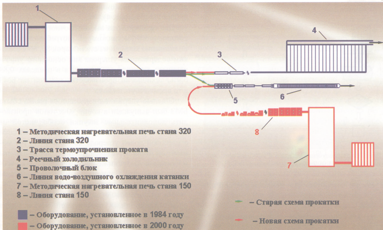
Рис. 5. Технологическая схема станов 320 и 150 после внедрения новых технологий
