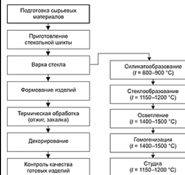
Рис.2.4.11. Схема производства стекла
