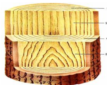
Рис.2.1.12. Рисунок текстуры древесины в зависимости от направления среза 1-торцевого, 2- радиального, 3 -тангенциального
