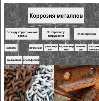
Рис.2.6.38. Виды коррозии металлов
