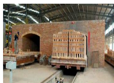
Рис.2.3.33. Туннельные печи для обжига
