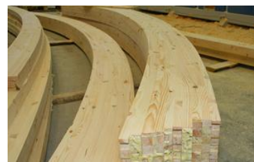
Рис.2.1.28. Клееные древесноклееные конструкции
