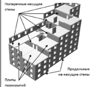
Рис.1.2.6. Конструктивные элементы многоэтажного здания
