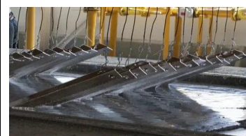
Рис.2.6.41. Горячее цинкование металлических изделий
