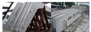
Рис.2.5.17. Рамы ж/б, балка-ферм
