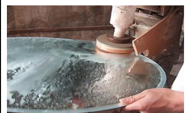
Рис.2.4.44. Полировка кромки зеркала
