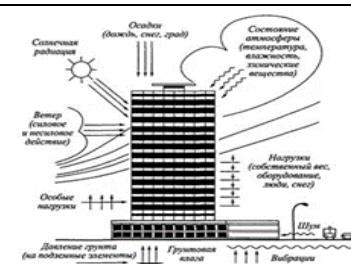
Рис.1.2.18. Факторы воздействия окружающей среды, определяющие требования к строительным материалам и изделиям
