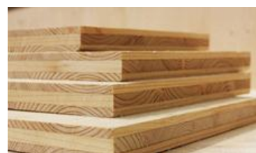
Рис.2.1.27. Клееные полуфабрикаты, 3-х слойная плита
