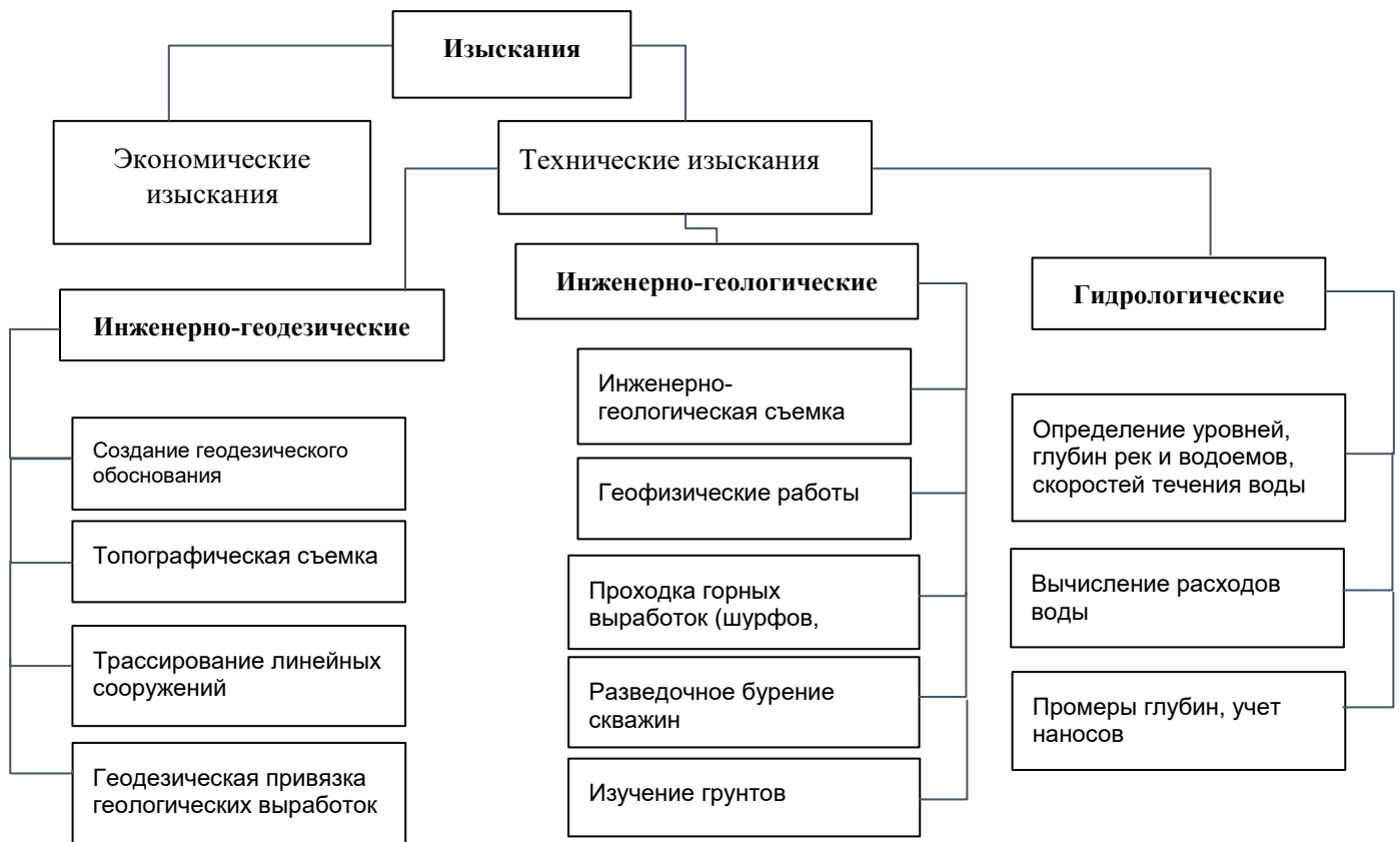
Рис. 1.2. Состав работ основных технических изысканий
