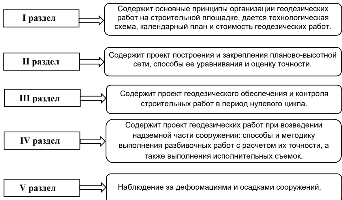
Рис. 1.3. Состав проекта производства геодезических работ (ППГР)
