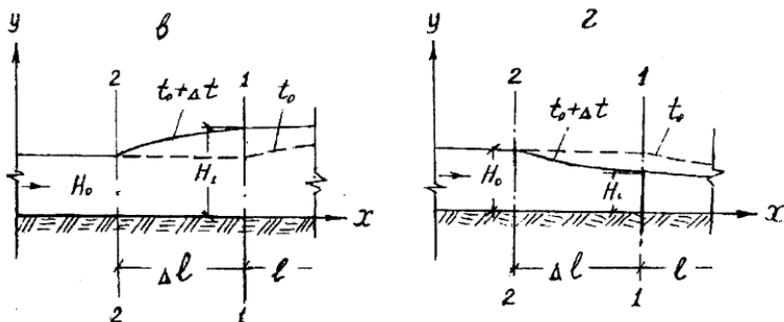
Расчетная схема движения волн попуска.
