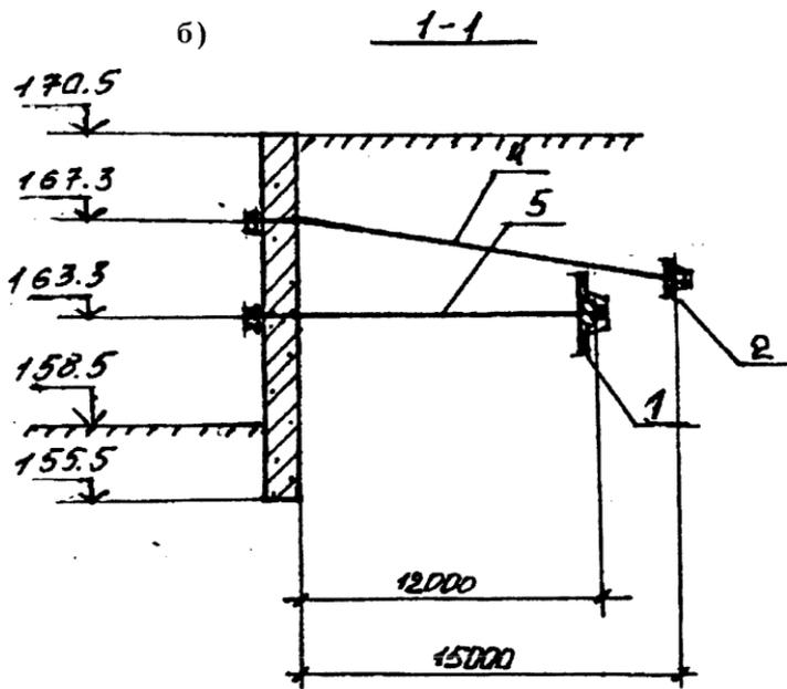
Рис.2. Устройство постоянных анкеров: а) – схема расположения,
