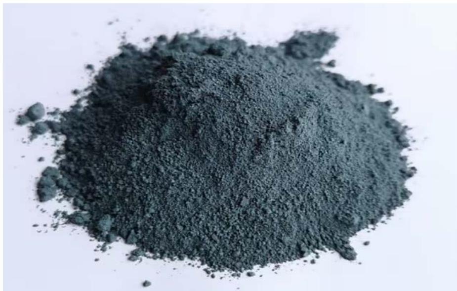
Рисунок 1 – Нанопорошок из марганца и оксида алюминия
