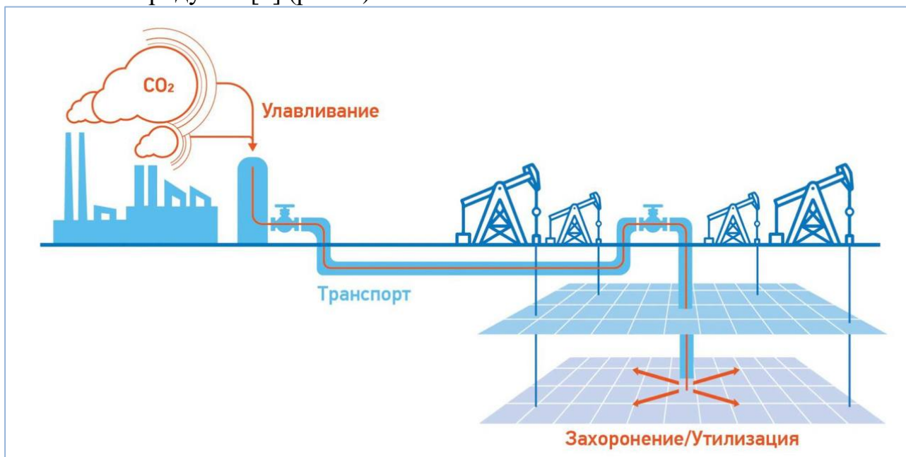
Рисунок 1 – Схематичное изображение технологии улавливания, утилизации и захоронения углекислого газа (CCUS) [1]
