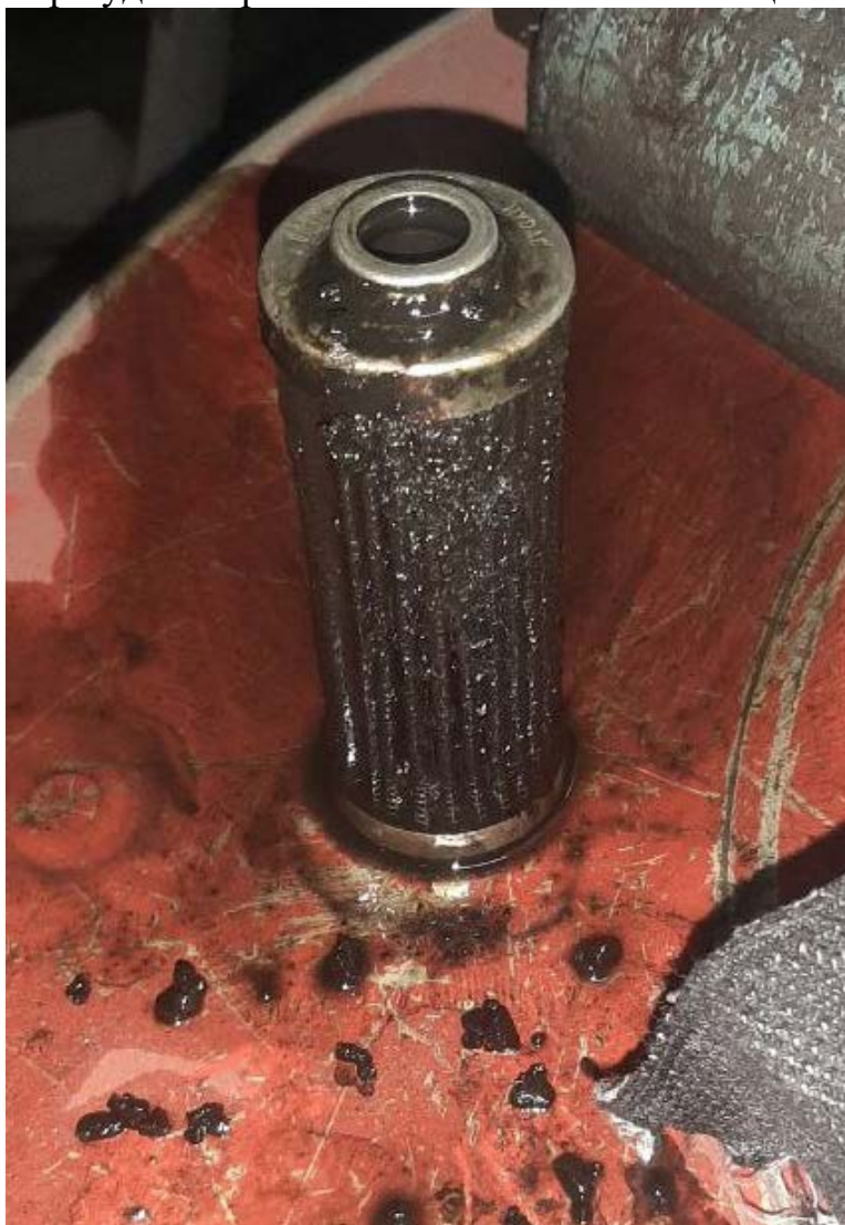
Рисунок 2 – Загрязненный фильтр насоса
