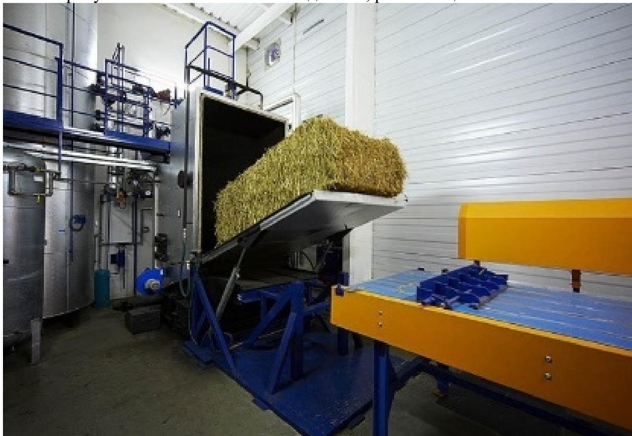
Рисунок 1 – Внешний вид котла, работающего на тюках соломы [2]
