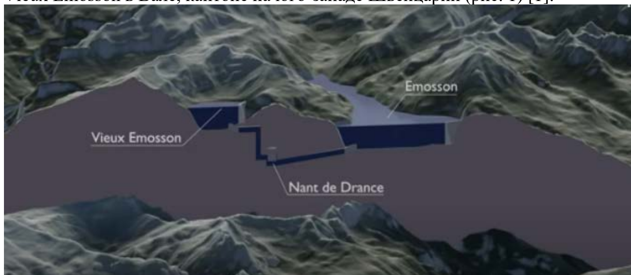
Рисунок 1 – Подземная ГАЭС Nant de Drance в Швейцарии [1]
