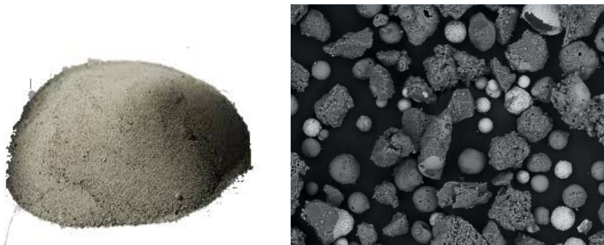
Рисунок 1 – Зола уноса и микрофотография образца микроSil [2]
