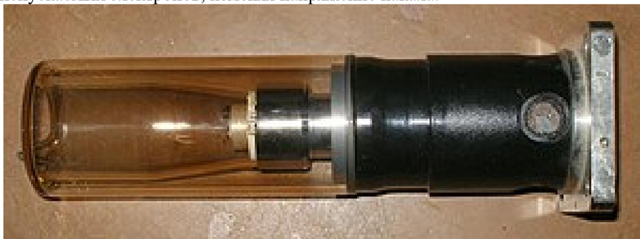
Рисунок 5 – Советская рентгеновская трубка для рентгеноструктурных исследований, источник низкоэнергетического рентгеновского излучения (справа видно бериллиевое окно, анод с водяным охлаждением, в средней части находится прямонакальный катод)
