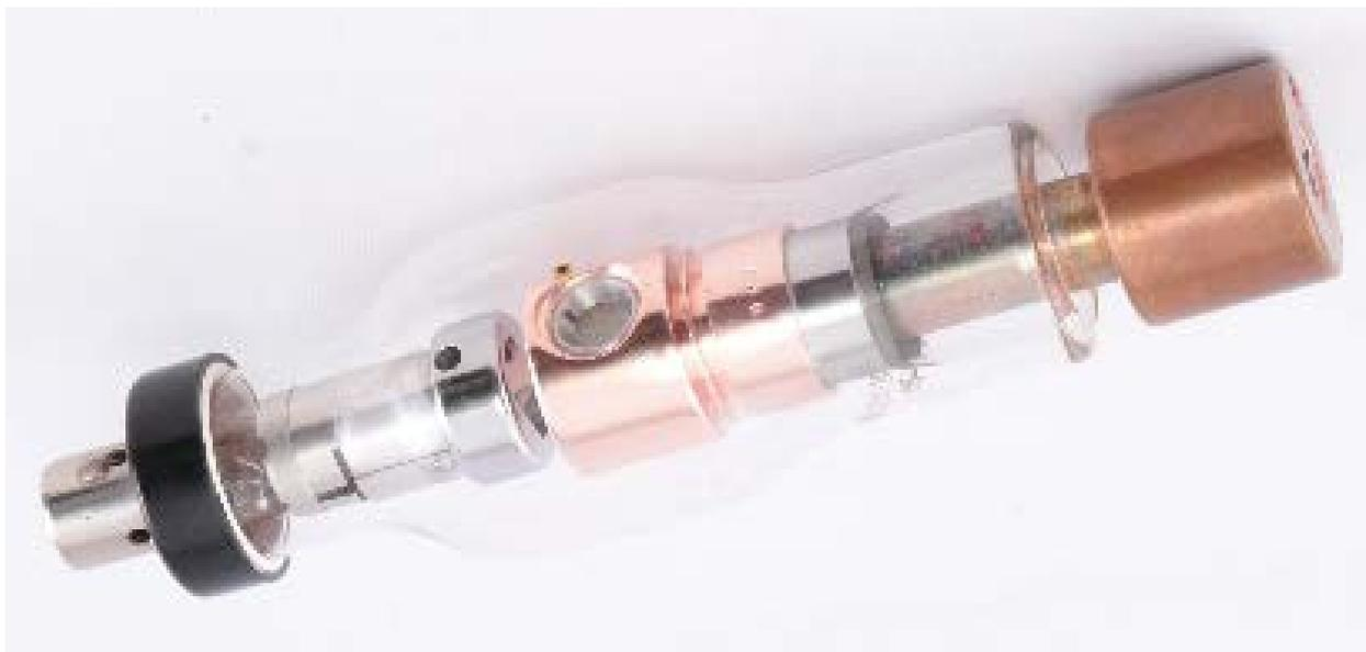
Рисунок 6 – Медицинская рентгеновская трубка ЗБДМ2-100 (произведена заводом «Светлана» СССР, 1979 год)
